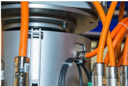
Poco appariscente ma efficace: collegamento via cavo tra anello collettore e sistema di azionamento.
