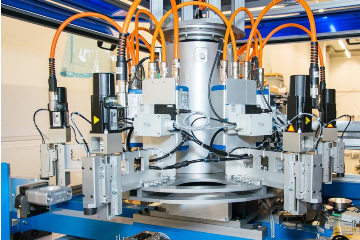
I servomotori della serie AKM di KOLLMORGEN si muovono sulla tavola rotante.
