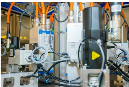
I servoazionamenti decentralizzati AKD-N sono posizionati intorno all'asse mediano della macchina occupando un ingombro minimo.
